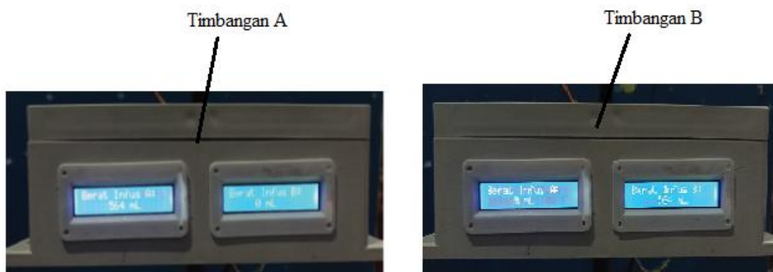
Gambar 15. Hasil Timbangan Menggunakan Load Cell A Dan B
