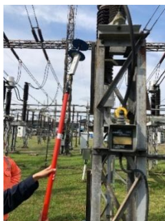
Gambar 2. Rangkaian alat pengukuran LCM
