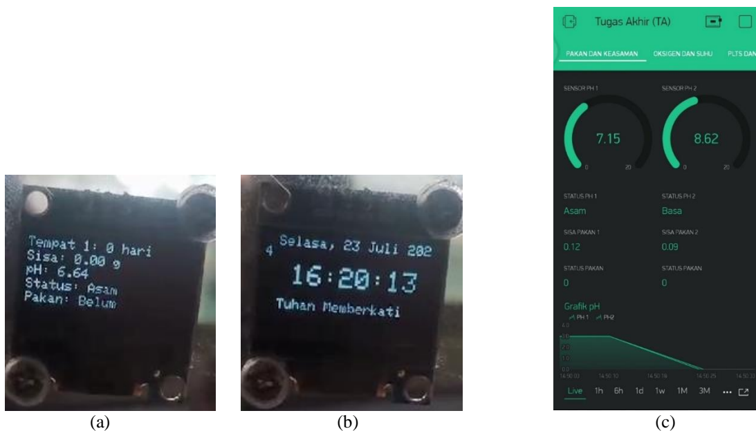
Gambar 6. (a). dan (b). Tampilan pada Layar OLED. (c). Tampilan pada Aplikasi Blynk
