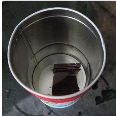
Gambar 2. Isolasi Kertas Yang Direndam Minyak Isolasi Transformator
