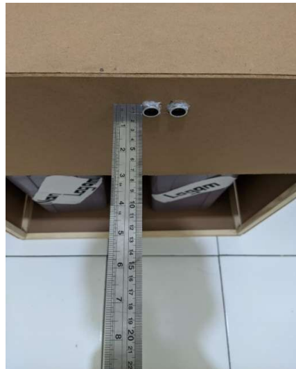
Gambar 10. Pengujian jarak sensor ultrasonik
