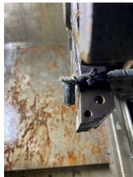
Gambar 6. Letak Pemasangan Sensor Suhu Pada Mesin
