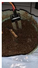
(d) Testing Soil moisture sensor
