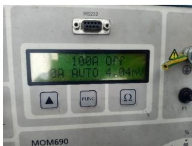
Gambar 9. Hasil pengukuran tegangan pada PMT fasa T
