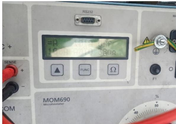
Gambar 4. Hasil tahanan kontak pada PMT fasa R.
