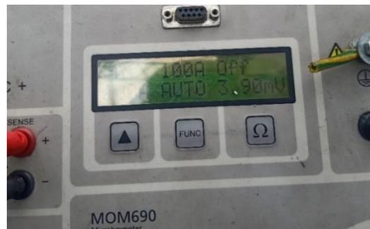
Gambar 7. Hasil pengukuran tegangan pada PMT fasa S
