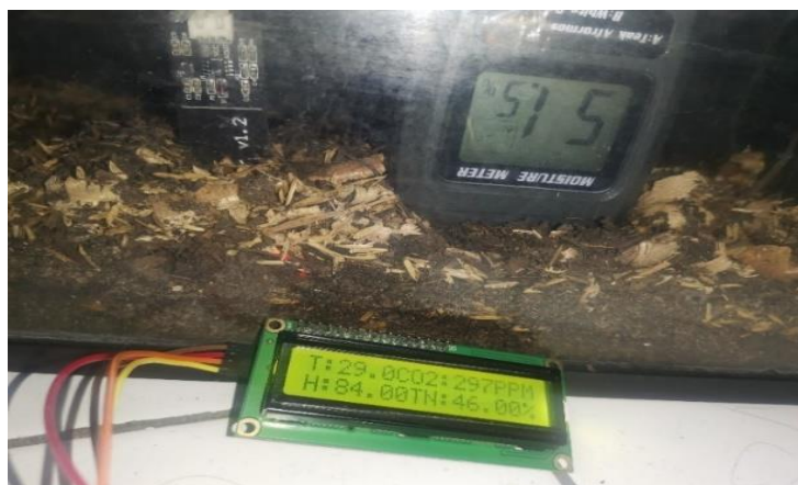
Gambar 9 Tampilan kalibrasi sensor Soil Moisture V1.2 dengan digital moisture meter.
