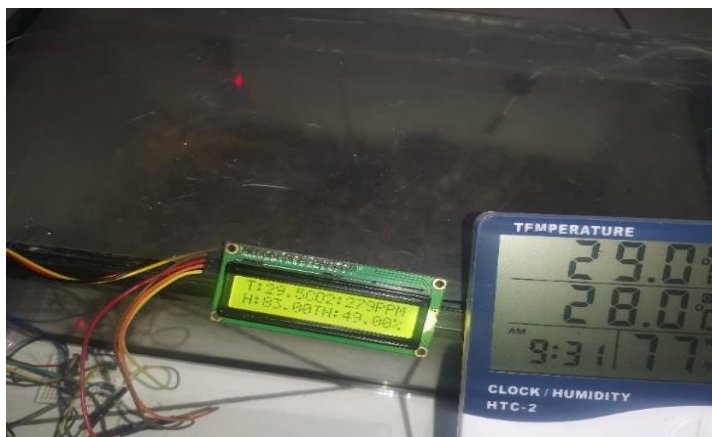
Gambar 8 Tampilan kalibrasi sensor DHT11 dengan HTC-2
