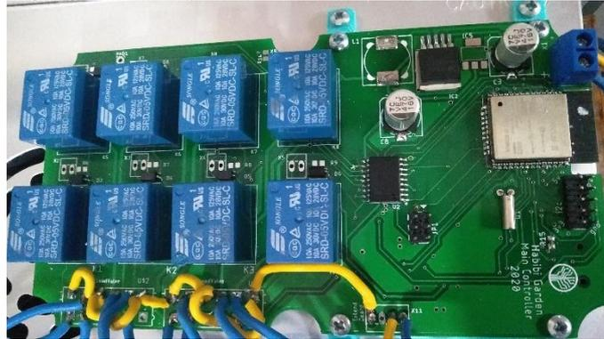
Gambar 3. Hasil Perakitan Board Alat penyiraman
