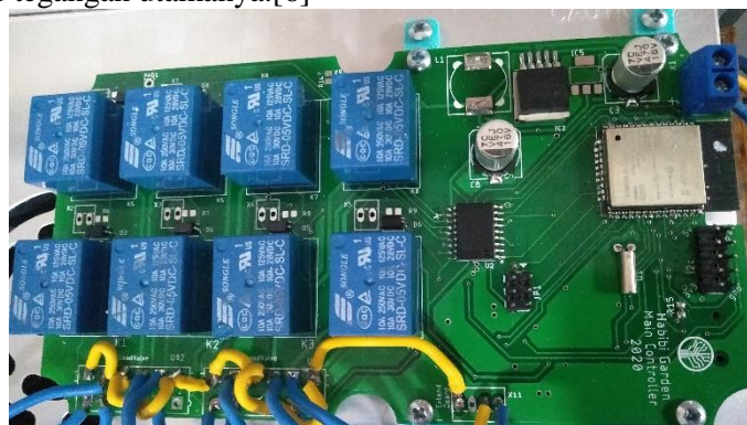
Gambar 3. Hasil Perakitan Board Alat penyiraman
