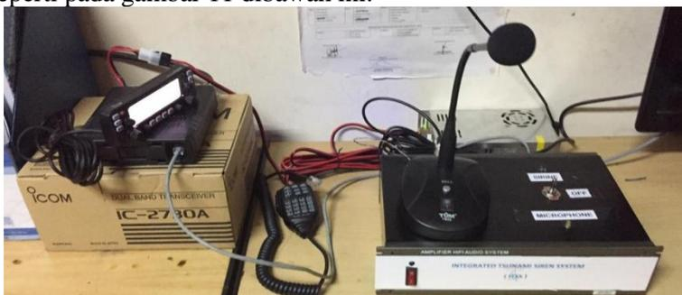
Gambar 11. Perangkat radio pemancar (Tx) yang diinstalasi di Pusdalops BPBD Provinsi Banten
