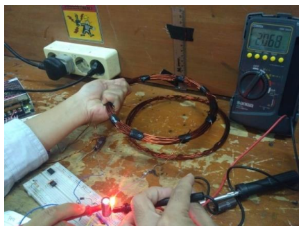
Gambar 4. Pengukuran pertama Tegangan Penerima pada jarak 5 cm
