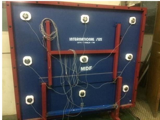
**Gambar 4. Letak Matriks Microphone 9x9**
