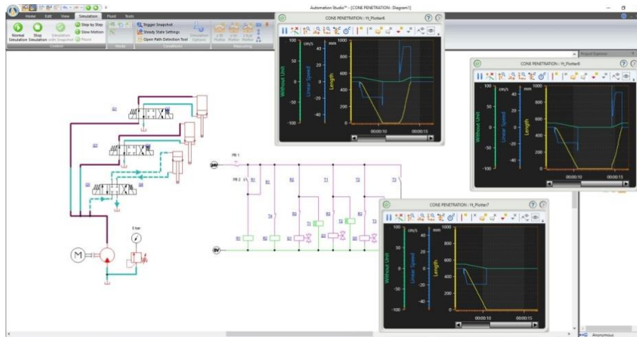
Gambar 9. Hasil simulasi dengan parameter linear position , linear speed dan output signal position selama 10-15 detik.
