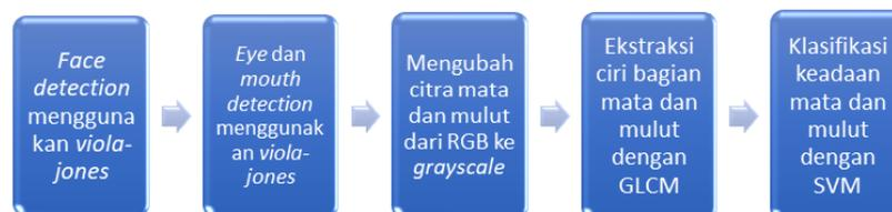
Gambar 7. Blok diagram sistem secara umum.
