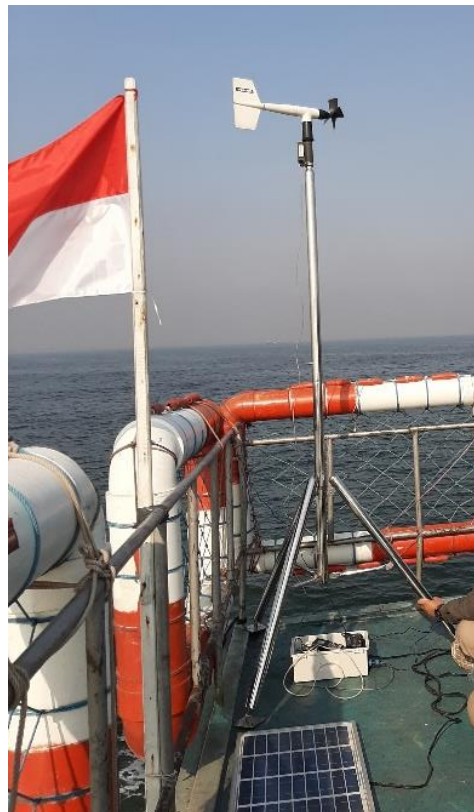
Gambar 4. Instalasi True Wind Sensor di kapal Garuda
