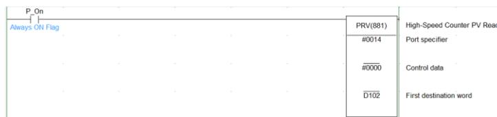
Gambar 3.6 Ladder diagram untuk pembacaan encoder
