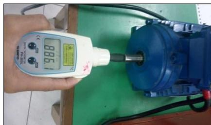
Gambar 3.7 Pengukuran rpm dengan Tachometer
