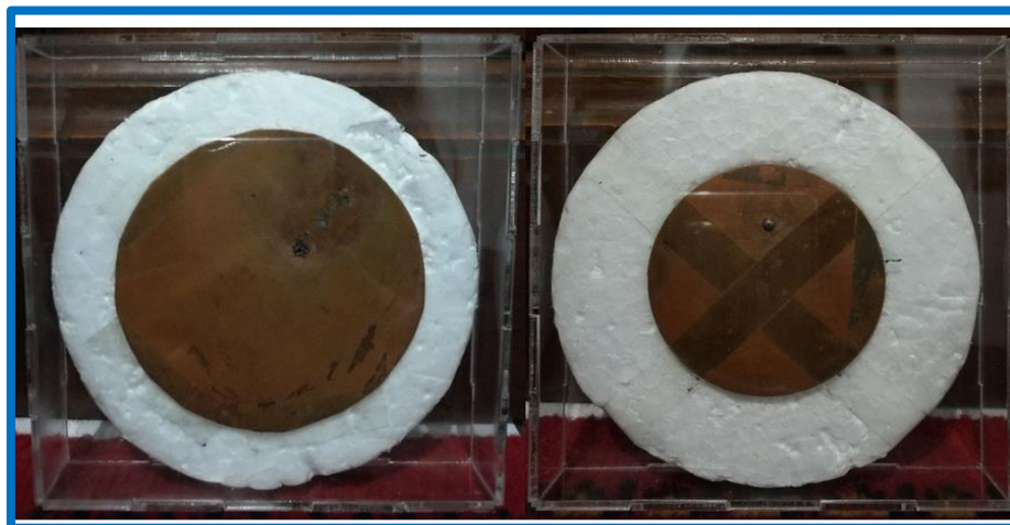
Gambar 7. Purwarupa antenna mikrostrip lingkaran, konvensional (kiri) dan artifisial (kanan)
