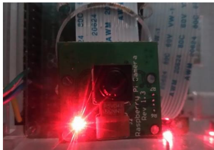
Gambar 3. Indikator Pada Pi Camera Menyala
