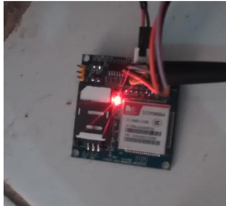
Gambar 2. Indikator Pada Modul SIM Menyala
