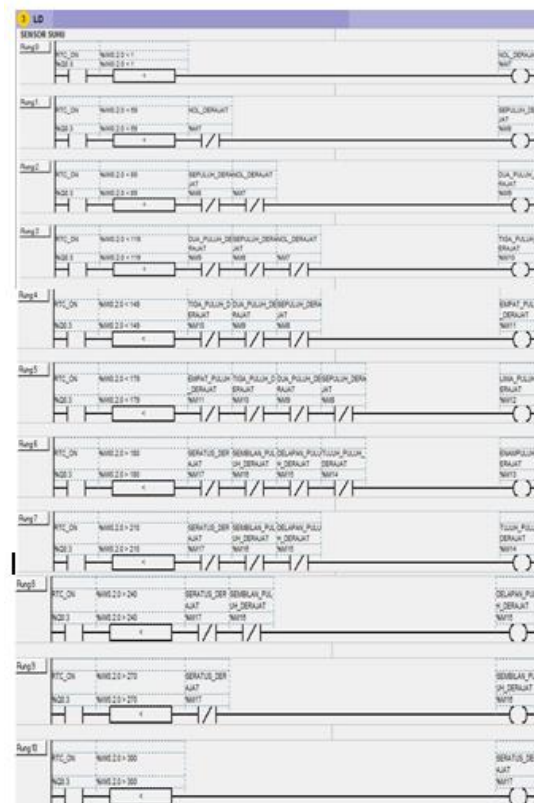
Gambar 5. Ladder diagram sensor termkopel pengatur kecepatan motor AC
