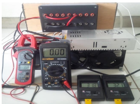
Gambar 5. Pengujian dengan Mengukur Suhu Heatsink ( Step 1)
