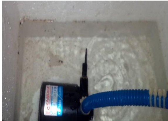
Gambar 6. Air Sebagai Media Penyalur Temperatur Dingin Dari Coldsink
