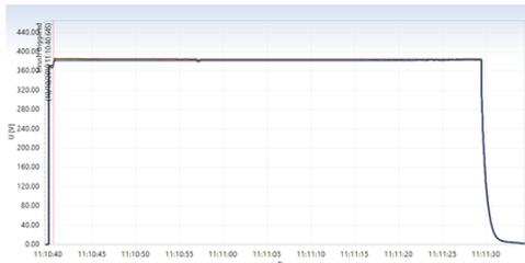
Gambar 12. Karakteristik tegangan sistem pengasutan DOL
